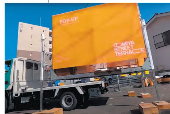
図2 POP-UPユニットはメッシュターポリンの壁面をヒンジによって外側に開くことで庇になり日影をつくる。
